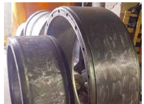
Рис. 3. Кольцевые матрицы после ремонта (восстановления)
