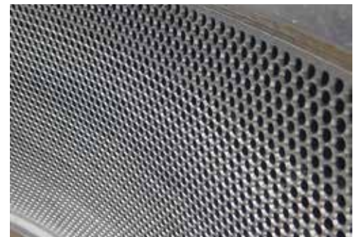
Рис. 2. Внутренняя рабочая поверхность матрицы ПОСЛЕ ремонта (восстановления)
