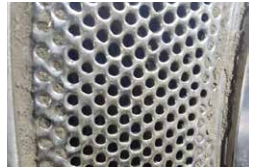
Рис. 1. Внутренняя рабочая поверхность матрицы ДО ремонта (восстановления)
