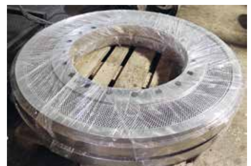
Рис. 4. Дисковые матрицы после ремонта (восстановления)
